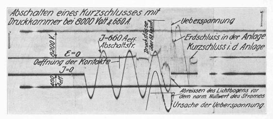
Fig. 4. — Coupure d'un court-circuit, avec chambre de compression. 8000 kVA et 660 A.
