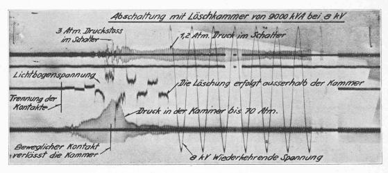
Fig. 3. — Coupure de 9000 kVA sous 8 kV, avec chambre de compression.
