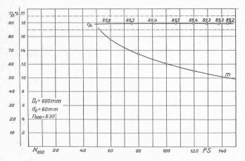
Fig. 2. — Turbine Pelton, d'essai, accusant un m égal à 10 (1927). Puissance ( $N_{100}$ ) et nombre de tours par minute ( $n_{100}$ ) rapportés à une chute de 100 m.
