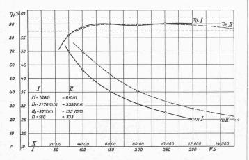
Fig. 1. — Comparaison de deux turbines Pelton accusant approximativement le même m (25) et datant I, de 1909 et II, de 1925.
