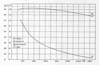
Fig. 3. — Turbine Pelton accusant un m égal à 6,55 (1926).
