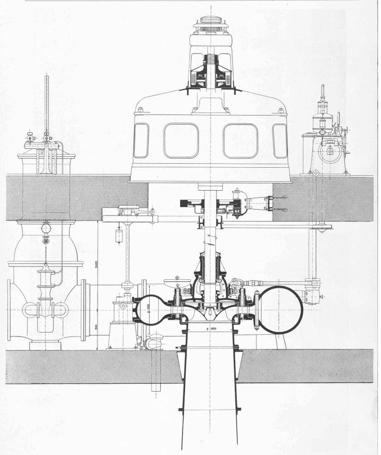
Fig. 18. — Turbine Francis spirale de l'usine de Broc, construite par les «Ateliers de constructions mécaniques de Vevey».
