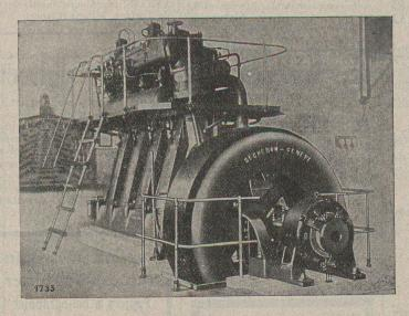
Alternateur triphasé 425 KVA, 6600 V, 50 pér: sec accouplé à un moteur Diesel 500 ch, 273 t : min.
