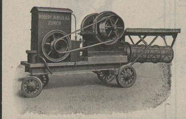
Coût du combustible pour la fabrication d'un m³ de ballast avec le moteur « Uto » environ 14 centimes au lieu de 54 centimes environ avec moteur à benzine.
