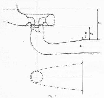
$H_{o}=$  Chute totale. —  $H_{st}=$  Hauteur statique d'aspiration.  $F_{1}=$  Section d'entrée du tube d'aspiration.  $F_{2}=$  " de sortie " " " "
