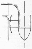
Fig. 2. — Schéma d'une turbine-hélice.
