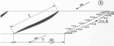
Fig. 3. — Répartition des pressions sur les faces des pales coupées suivant c-c, fig. 2.
