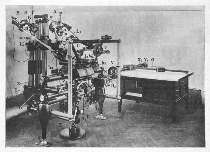
Fig. 1. — Vue du stéréoplanigraphe Zeiss.
