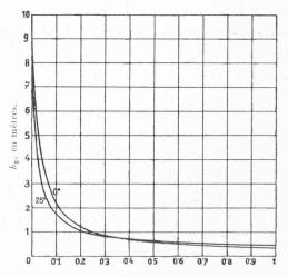
Fig. 2. — Quantités, en m³, d'air dégagé par m³ d'eau à 0° et 25° C. Pression atmosphérique : 9,6 m, d'eau.
