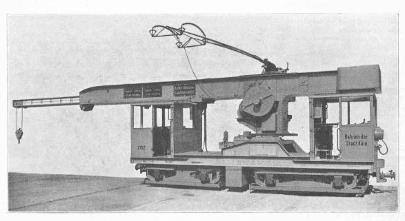
Grue à flèche télescopique pour la pose des voies de tramways.
