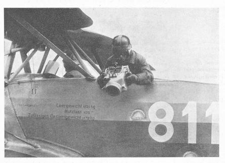
Fig. 1. — Levé au moyen d'un appareil incliné, tenu à la main.
