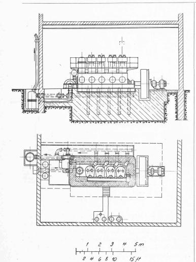
Fig. 4. — Installation d'un moteur Diesel de 600 ch suralimenté par turbo-soufflante à gaz d'échappement.
