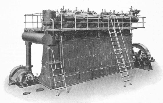
Fig. 6. — Moteur Diesel de 1700 ch suralimenté par turbo-soufflante à gaz d'échappement.
