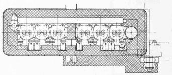
Fig. 2. — Moteur Diesel de 1700 ch suralimenté par turbo-soufflante à gaz d'échappement.
