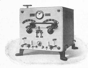
Fig. 3. — Poste de soudure à étincelle-pilote.
