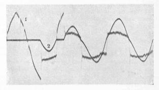
Fig. 2. — Oscillogramme de l'allumage d'un arc de soudure par étincelle-pilote.
