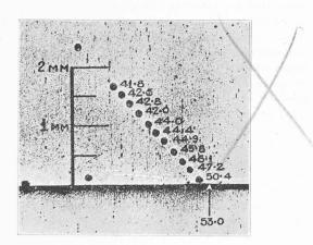
Fig. 3. — Microphotographie montrant la variation de la dureté en fonction de la profondeur de la couche superdurcie d'un acier au nickel-chrome.
