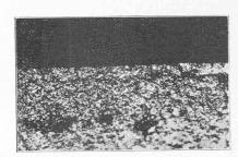
Fig. 1. — Couche superdurcie à la surface, rompue, d'un acier trempé, à haute teneur en carbone.
