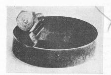
Fig. 5. — Acier doux cémenté et superdurci. La lettre H «réservée », est dessinée par le mitraillage de la surface dotée d'un poli spéculaire (image par réflexion de la vis).
