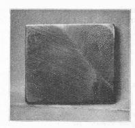
Fig. 4. — Acier doux, cémenté puis «mitraillé». Le mitraillage décèle les régions « douces » et l'angle où la couche cémentée a été meulée.
