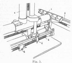
Fig. 3-5. Mécanisme de restitution de l'aérocartographe.
