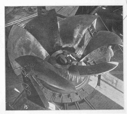
Fig. 5. - Usinage d'une turbine Lawaczeck.
