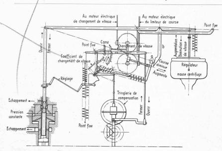
Fig. 6. — Schéma du régulateur Finshyttan.
