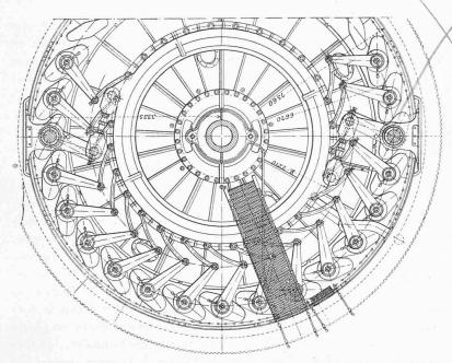
Fig. 3. — Anneau de vannage et commande des aubes distributrices.
