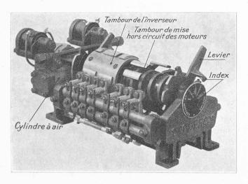
Fig. 4b. — Inverseur; vue du côté du tambour de mise hors circuit des moteurs.
