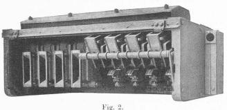
Batterie de contacteurs électro-pneumatiques. Vue de devant dans sa position normale; protection en partie enlevée.
