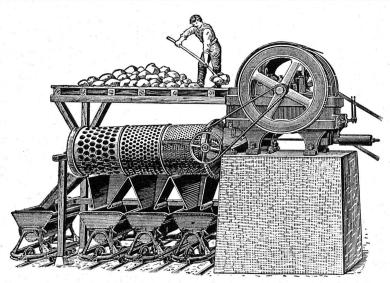
Broyeur et concasseur pour fabrication du sable
