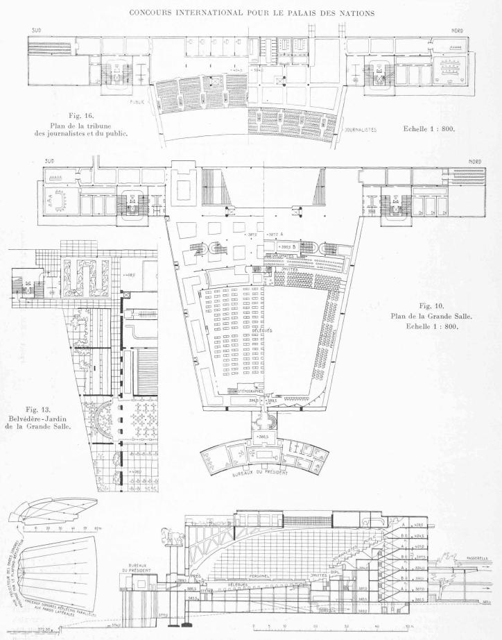
Fig. 11. — Coupe de la Grande Salle et épure de l'acoustique.
