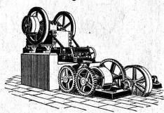
Concasseur-Broyeur pour fabrication du sable de roche dure.
