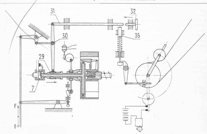
Fig. 5. — Schéma du régulateur des Ateliers des Charmilles S. A.
