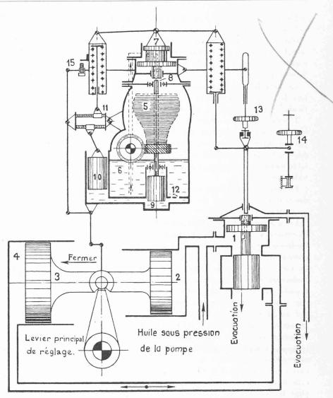
Fig. 6. — Schéma du régulateur Escher, Wyss & Cie.
