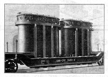
Grandes cuves à huile, pour transformateurs électriques. TURBINES HYDRAULIQUES RÉGULATEURS
