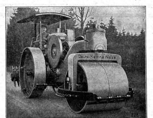
Plus grande écononomie d'entretien et de carburant: Consommation env. 20 kg. d'huile lourde par 10 heures de travail. Réduction des frais d'entretien jusqu'à 70 % sur benzine, benzol, ou vapeur. Construction la plus perfectionnée. Mise en marche immédiate, départ silencieux et sans secousses.
