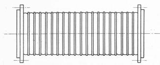
Fig. 1. — Tuyau multionde fretté.
