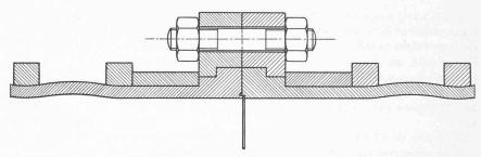
Fig. 4. — Joint d'une conduite en tuyaux multiondes frettés. Diamètre : 1400 mm. Hauteur de la chute : 1750 m.
