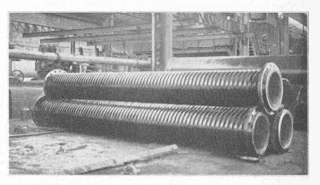
Fig. 2. — Tuyaux multiondes frettés pour la chute des Sept Laux (Société générale de Force et Lumière).
