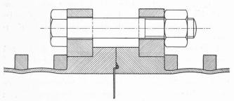
Fig. 3. — Joint d'une conduite en tuyaux multiondes frettés. Diamètre : 600 mm. Hauteur de la chute : 1050 m.
