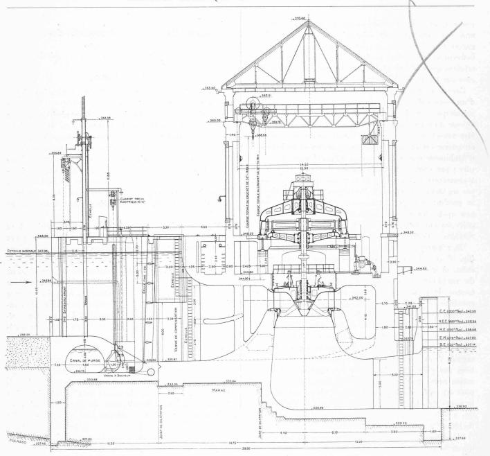
Fig. 3. — Coupe transversale de l'usine de Chancy-Pougny, par la turbine 4. — Echelle 1: 250.
