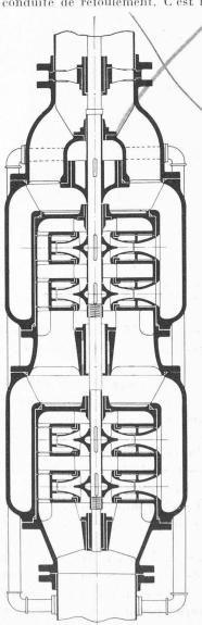
Fig. 1. — Coupe d'une pompe centrifuge de forage Sulzer, à haute pression. Deux groupes en série comprenant chacun 2 étages en parallèle.
