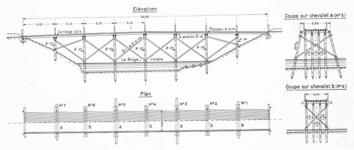
Fig. 4. — Pont de pilotis pour camions de 10 tonnes. — Echelle 1:300.
