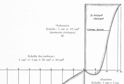
${\rm Fig.~3.}$  Détermination du moment centrifuge d'une surface à l'aide de l'intégraphe, par la méthode Amsler.
