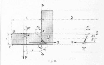
section A, B,  $A_1$ ,  $B_1$  en plus des efforts de flexion dans la section d'encastrement des efforts de traction et de compression dans le sens circonférenciel de la bride.
