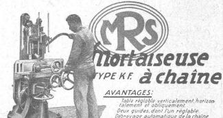
Deux guides, dont l'un réglable. Débrayage automatique de la chaîne, dans sa position supérieure, la preser, ant contre l'usure.
