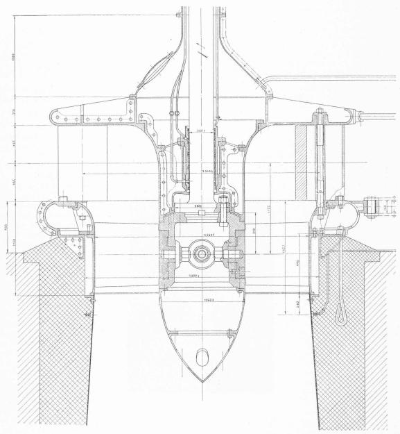
Fig. 2. — Turbine-hélice de Chicoutimi. — Echelle 1:30. Construite par Escher Wyss &  $C^{1e}$ .
