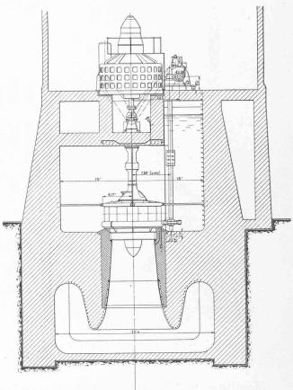
Fig. 1. — Turbine-hélice de Chicoutimi. Echelle 1: 200.
