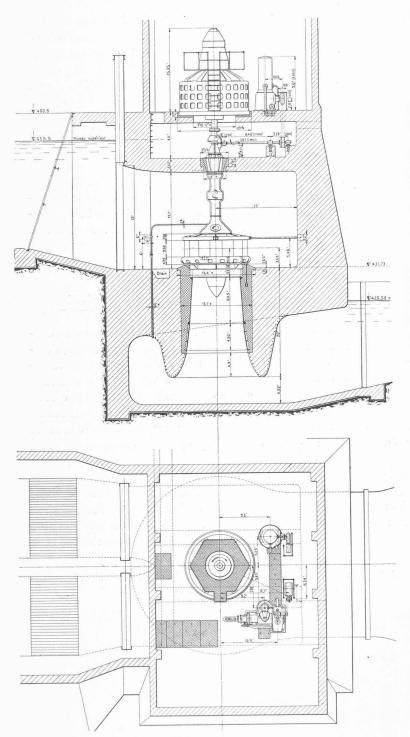
deuxième par un tube de Prasil. La turbine, à axe vertical, est accouplée directement avec l'alternateur (Voir fig. 1) Le fond du distributeur et la bâche de la roue mobile à laquelle il est fixé sont, afin d'être facilement remplaçables en cas d'usure par la corrosion, boulonnés sur un anneau en fonte scellé dans la fondation. La roue réceptrice, d'un diamètre de 2650 mm., est munie de 4 aubes en acier moulé, boulonnées sur le moyeu.
