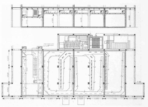
Fig. 9. — Plan et coupe du rez-de-chaussée constituant la partie municipale du frigorifique.
