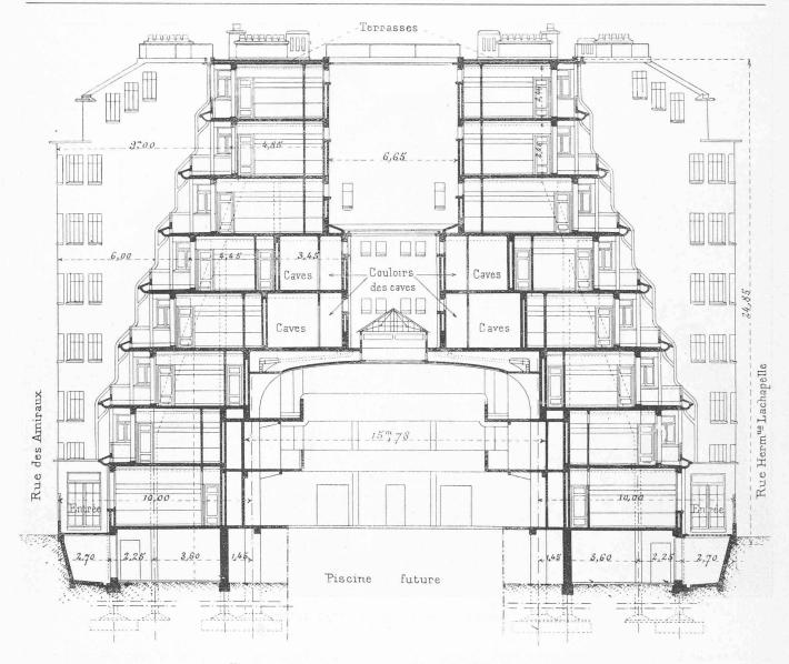
Fig. 3. — Coupe transversale a-b (voir fig. 2) de l'immeuble.
