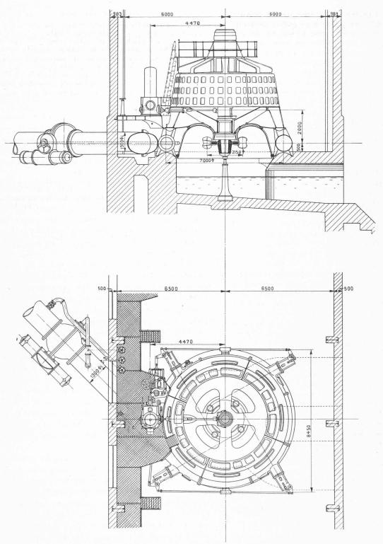
Fig. 1. — Turbine Pelton à axe vertical de Maipo. Echelle 1:150.  $H=204~\mathrm{m.} - Q=8.2~\mathrm{m}^3:\mathrm{s.} - P=17500~\mathrm{ch.} - n=250~\mathrm{t:min.}$  Construite par Escher, Wyss &  $C^{\mathrm{te}}$ .
