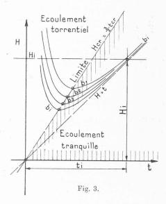
Mais, comme le tronçon  $L_1$  présente en général une largeur variable, il sera nécessaire de déterminer les constantes  $C_1$ ,  $C_2$ ,  $C_i$  correspondant aux différentes largeurs  $b_1$ ,  $b_2$ ,  $b_i$ , de sorte que l'on est appelé à concevoir tout un réseau de courbes  $H = f_i(t)$  (fig. 3). On peut observer que toutes ces courbes sont homothétiques entre elles.
