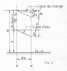
et  $\pi'$  distants de dx. Soit df la perte de charge due au frottement dans l'élément dx. Il est évident que lorsque le régime est établi, on doit avoir
