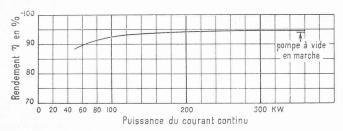
Fig. 5. — Rendement total déterminé par mesure directe de l'installation complète du redresseur et du transformateur, en fonction de la puissance du courant continu.
