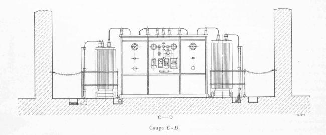
Fig. 2. — Sous-station de redresseur et commutatrice automatique de Saint-Légier.
