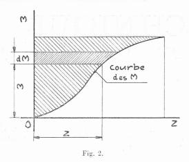
entre : l'axe de révolution, le plan origine, la courbe méridienne et le rayon d'abscisse z, cette valeur M étant portée en fonction de l'abscisse z, l'intégrale  $\int z dM$  du numérateur n'est autre que la portion de surface comprise entre l'axe des ordonnées, la courbe des M et l'horizontale passant par le point extrême de cette courbe. (Fig. 2.)
