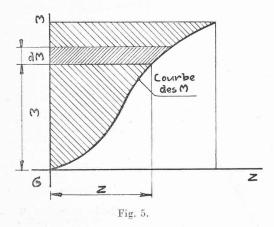
Le calcul des moments d'inertie polaires  $I_x$  et  $I_y$ du corps de révolution par rapport aux axes Gx Gy se ramène donc à des planimétrages et des déterminations de moments statiques de diverses surfaces, opérations toutes effectuables à l'aide de l'intégrateur.
