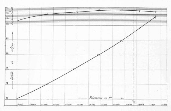
Fig. 18. — Courbes des débits et des rendements de la turbine Nº 16, de 37500 HP. de l'Usine Nº 3 de Niagara.
