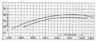
Fig. 12. — Première courbe de rendements établie à l'aide de la méthode Gibson, le 9. XI. 1919 (courbe inférieure). La courbe supérieure fut établie en 1907-8 à l'aide d'un tube de Pitot.
