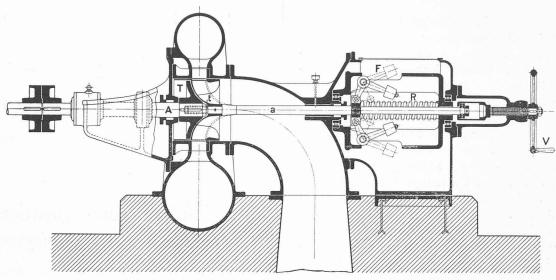
Fig. 2. — Turbine auto-régulatrice, système Crozet-Fourneyron (accouplement direct).
