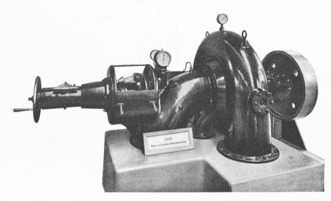
Fig. 3. — Turbine auto-régulatrice Crozet-Fourneyron, à accouplement direct.
