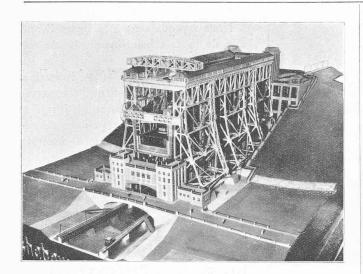
Fig. 3. — Maquette, à l'échelle 1 : 50, de l'élévateur à bateaux (36 m. de hauteur) de Niederfinow sur le canal de Hohenzollern. Type avec transport d'eau, adopté pour la construction.
