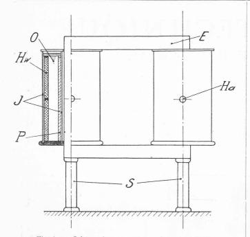
Fig. 1. — Schéma du nouveau transformateur BBC. Légende: J = cylindre isolant. - O = huile. - Hw = enroulement haute tension, - P = enroulement basse tension. - E = circuit magnétique, - Ha = borne haute tension. - S = isolateurs-supports.
