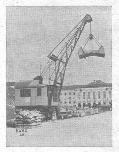
LEVAGE PAR BENNE AUTOMATIQUE
