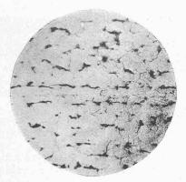
Fig. 4. — Microphotographic du métal de la pièce à souder. Grossissement: 400 diamètres.
