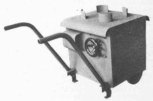
Fig. 3. — Appareil Sécheron pour soudure électrique à l'arc.
