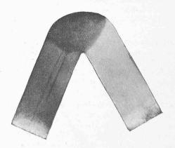
Fig. 8. — Soudure attaquée à l'acide.
