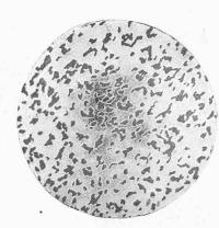
Fig. 5. — Microphotographie du métal d'apport. Grossissement : 400 diamètres.
