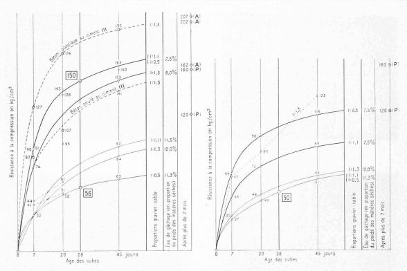
Fig. 5. — Résistances à la compression des bétons obtenus avec le matériau E.
