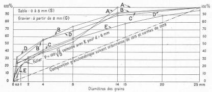
Fig. 1. — Résultats du tamisage des tout-venants A à E, comparés aux compositions granulométriques idéales d'après Fuller et d'après les règlements.
