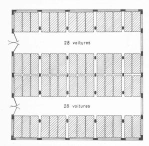
Fig. 4. — Plan d'un garage à rez-de-chaussée.
