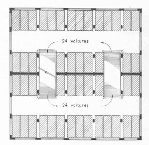
Fig. 5. — Plan d'un garage à étages avec rampes d'Humy.
