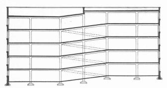
Fig. 1. — Coupe schématique d'un garage système d'Humy.
