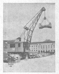
LEVAGE PAR BENNE AUTOMATIQUE
