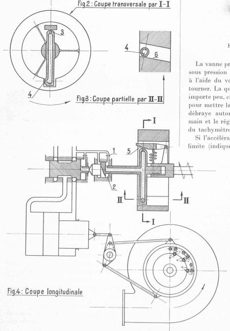
Fig. 2 à 4. — Représentation schématique du régleur.
