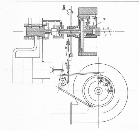
Fig. 10. — Ensemble schématique du régleur.
