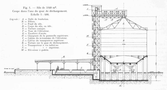
quatre faces dont les sommets se trouvent aux ouvertures de soutirage. Les faces intérieures de ces quatre pyramides se coupent suivant deux arêtes horizontales, tandis que les faces extérieures sont limitées par la bordure cylindrique sur laquelle repose la paroi métallique du silo. L'inclinaison des faces est de 35° pour assurer un bon écoulement de l'alumine dont le talus naturel d'éboulement est d'environ 30°.
