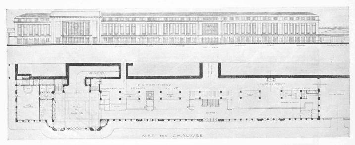
Façade principale et plan du rez-de-chaussée. — 1:1000.
