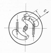
Fig. 1. — Régulateur-volant avec action accéléro-tachymétrique.
