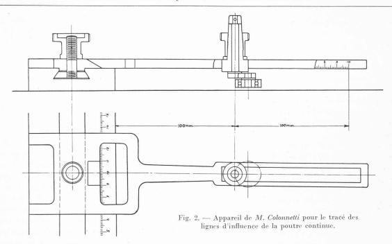
pourra prendre le ruban en s'infléchissant : elle dépend seulement de la position que nous avons donnée au support du pivot, position qui, dans l'instrument, est complètement déterminée au moyen des échelles graduées en millimètres tracées sur la règle et sur le côté de chaque coulisse.
