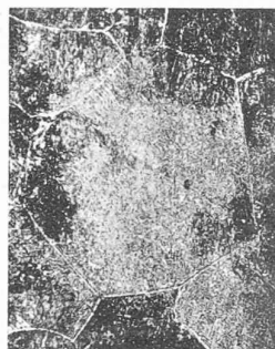
Fig. 2. — Le même acier chauffé 5 minutes à 1400-1500°C, puis refroidi lentement à l'air. Résilience : 7.
